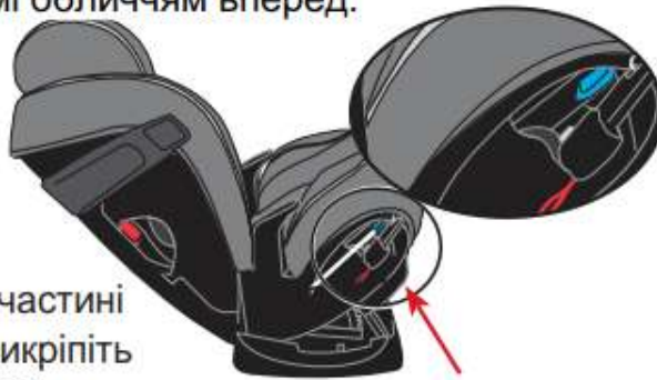
Місце для зберігання вузла LATCH (UAS) в режимі обличчям назад
