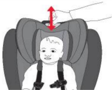
**NOTA:** La solapa de la cabecera está diseñada con tres líneas de pliegue para permitir el almacenamiento parcial o total. Si usa las posiciones más bajas de la cabecera o el arnés, asegúrese de insertar el exceso de la solapa de la cabecera detrás de si misma.
