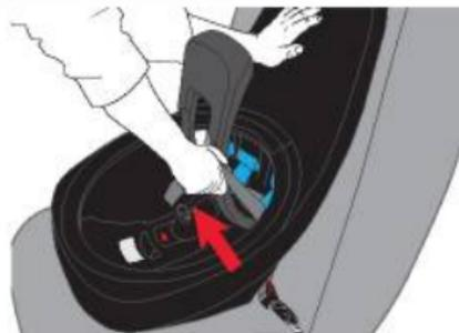
9. Після затягування НДСК \ УСК закріпіть надмірну довжину стрічки під LockStrong.
