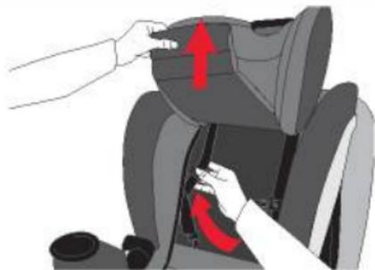
4. Від'єднайте гачки від петель, що кріплять подушку сидіння до задньої накладки.
