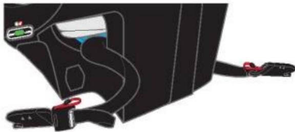
Siga las instrucciones de esta sección para instalar correctamente los conectores del anclaje inferior en su asiento infantil para el automóvil.
