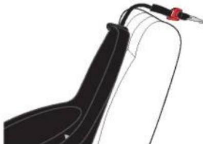
5. Localice el anclaje de la correa de sujeción en su vehículo y fije el gancho de sujeción al anclaje de la correa de sujeción sin apretarlo.
