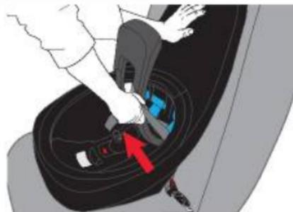
7. Після затягування НДСК / УСК закріпіть надмірну стрічку під LockStrong.
