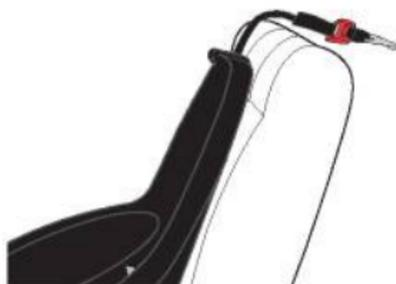
4. Localice el anclaje de la correa de sujeción en su vehículo y fije el gancho de sujeción al anclaje de la correa de sujeción sin apretarlo.
